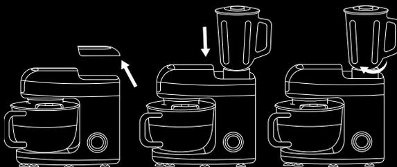
1. Снимите защитную крышку блока для установки кувшина блендера и зафиксируйте кувшин блендера в блоке, повернув его по часовой стрелке.
