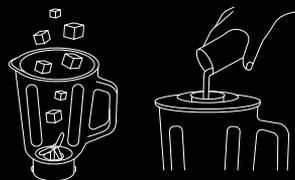
4. При необходимости добавляйте дополнительные ингредиенты в блендер, используя колпачок, через отверстие в крышке, не останавливая работу прибора.
