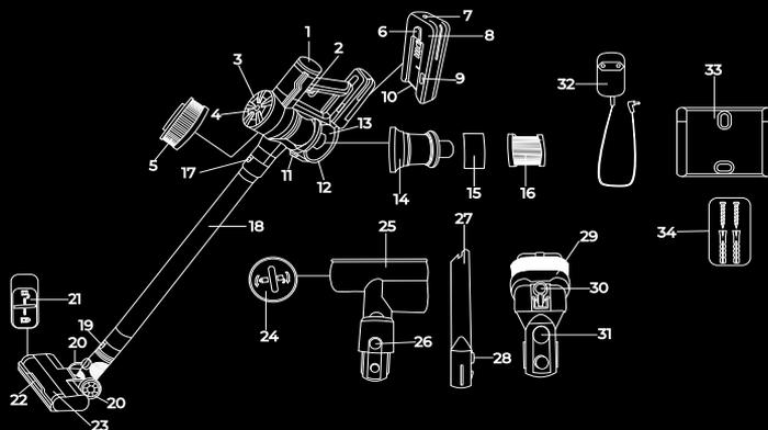
24. Фиксатор ролика электрической мини-турбошетки
