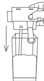
5. Вставьте собранную систему автоматического вспенивания молока в выемку для крепления и надавите на нее до упора.
