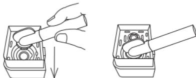
3. Вставьте трубочку для забора молока в соединительный клапан внутри крышки резервуара для молока.
