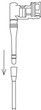
2. После этого поверните обнажившуюся пластиковую насадку стимера против часовой стрелки и потяните за нее, чтобы снять.
